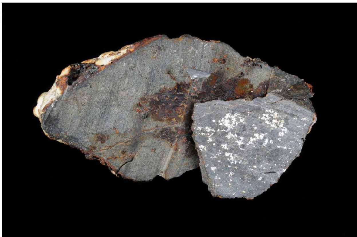
Zdjęcie Danebury po przecięciu w Open University. Łatki rdzy utworzyły się na powierzchni po pierwotnym cięciu. Jasny, biały metal widać na powierzchni po cięciu celem wykonania płytki cienkiej. Fot. A.Tindle, Open University.
