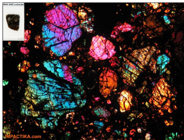
skale o równokrystalicznej i drobnokrystalicznej strukturze. Polaroidy skrzyżowane. Szerokość pola widzenia około 3 mm. Fot. John Kashuba.
