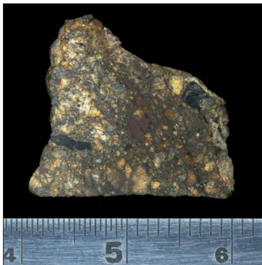
Fot. 4. Mieszanina ziaren mineralów, ciemnych okruchów i metalu. Polimiktyczny ureilit DaG 319. Płytkę ma 2 cm szerokości.
