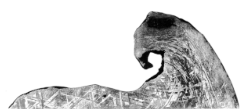
Fot. 1. Skrajne deformacje bryły meteorytu żelaznego spowodowane wytworzeniem się ciepła w masie żelaza oraz „obróbką na zimno” w wyniku gwałtownego rozerwania bryły żelaza w górnych warstwach atmosfery.
