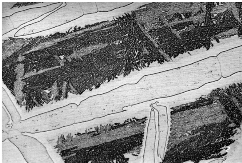
Fot. 1. Mikrostruktura meteorytu Taza z widocznymi wrzecionami kamacytu (50×)
