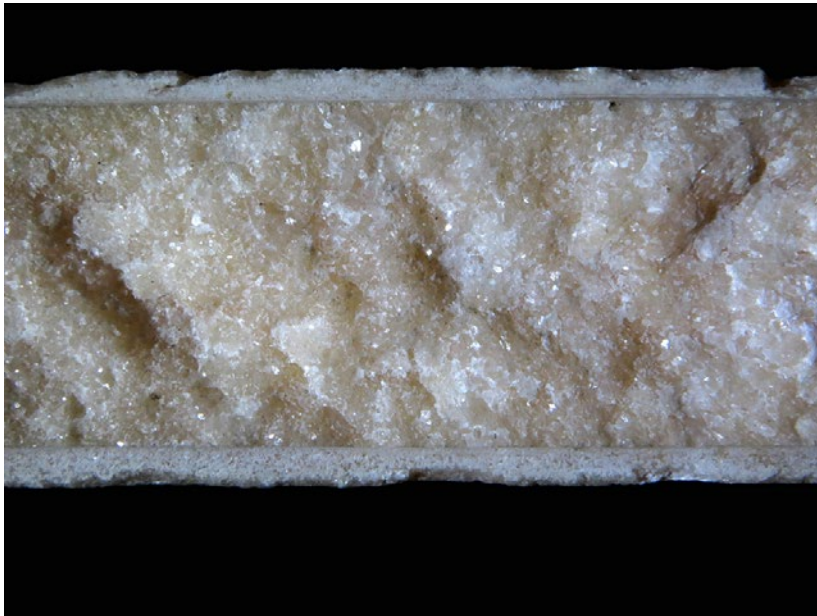
Fot. 5. Odlamana krawędź płytki różowego marmuru o grubości 38 mm. Na Ziemi osadowy wapień może stać się krystalicznym marmurem w wyniku rekrytalizacji w stanie stałym pod wpływem intensywnego ciepła i ciśnienia,
