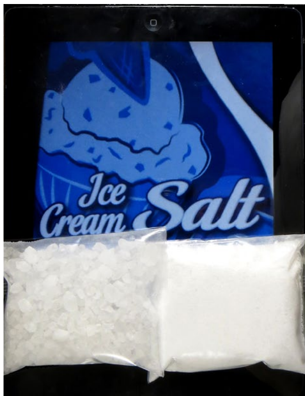
Fot. 4. Dwa plastikowe woreczki z solą leżą na ekranie tabletu w oświetlonym pokoju (z lewej) i w ciemnym pokoju. Dolna część ekranu, pod woreczkami, jest jaskrawo biała. Lewy woreczek zawiera sól gruboziarnistą. W prawym woreczku jest ta sama sól sproszkowana w mikserze. Waga i grubość woreczków jest taka sama. Gruboziarnista sól przepuszcza światło, sproszkowana sól zasłania je.
