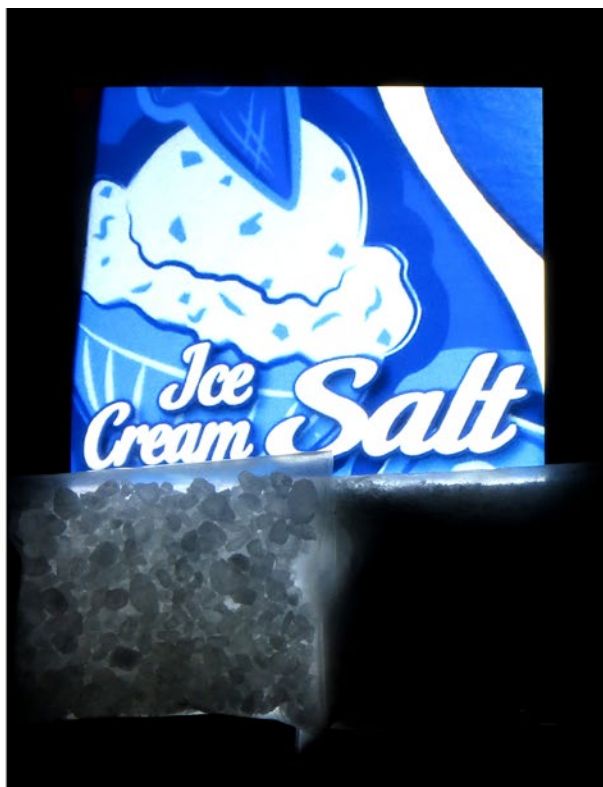
Fot. 4. Dwa plastikowe woreczki z solą leżą na ekranie tabletu w oświetlonym pokoju (z lewej) i w ciemnym pokoju. Dolna część ekranu, pod woreczkami, jest jaskrawo biała. Lewy woreczek zawiera sól gruboziarnistą. W prawym woreczku jest ta sama sól sproszkowana w mikserze. Waga i grubość woreczków jest taka sama. Gruboziarnista sól przepuszcza światło, sproszkowana sól zasłania je.
