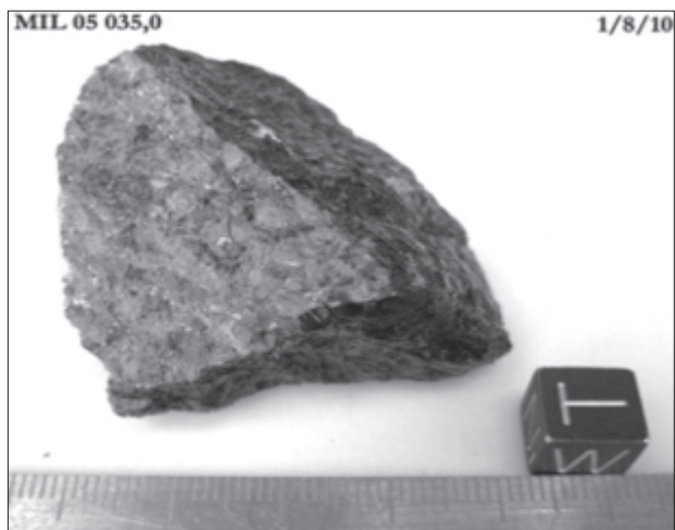
Fot. 5. Widok wnętrza meteorytu księżycowego Miller Range (MIL) 05035. Ta próbka zawiera maskelynit, ma 3,9 mld lat i jest fragmentem Księżyca, którego cechy nie przypominają żadnego okazu z przywiezionych przez wyprawę Apollo.
