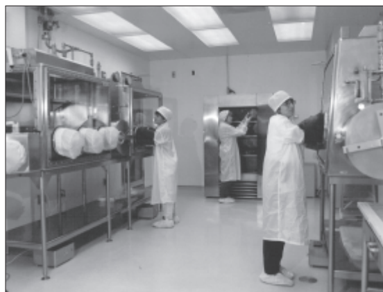
Fot. 2. Laboratorium obróbki Meteorytów Antarktycznych w Johnson Space Center. Widoczne są wypełnione azotem gabloty do obróbki z rękawicami, zapewniające bezpieczne, ochronne środowisko do obróbki próbek meteorytów.
