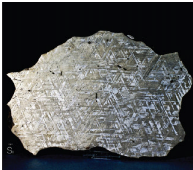
Fot. 4. Gibeon jest znany z łatwych do wytrawienia, charakterystycznych figur Widmanstättena. Na pokazanej na zdjęciu płycie ważącej 1157 g widać kilka wydłużonych wrostków troilitu często otoczonych zawiniętym kamacytem. Kostka skali na zdjęciu ma bok 1 cm.
