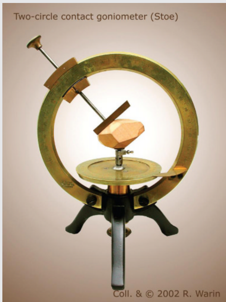
Mosiężny goniometr kontaktowy, złożony z dwóch kół, typ Stoe, z drewnianym modelem kryształu datolitu.
