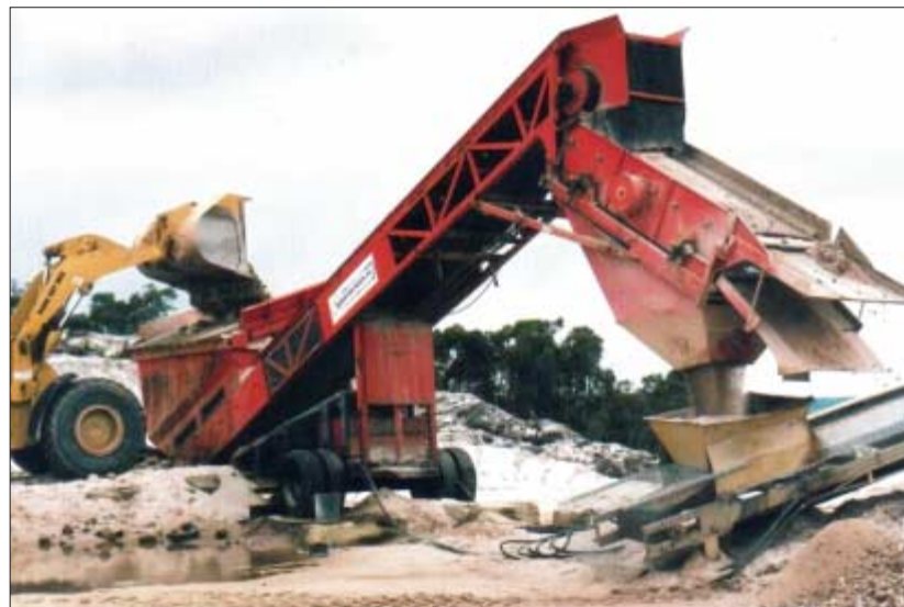
Fot. 3. Maszyna do oddzielania tektytów w działaniu. Piasek jest przesiewany przez ruchomą, wibracyjną maszynę do przesiewania. Proszę zauważyć, jak dużo piasku przechodzi przez sito, a tylko kilka zbyt dużych kamyków trafia do odrzuconego materiału po prawej.
