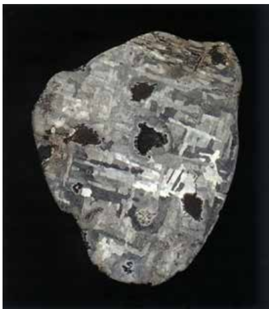
Płytkę meteorytu Nantan z przebarwieniami po rdzewieniu. Meteoryt został oczyszczony odrdzewiaczem i wytrawiony chlorkiem żelazowym. Doskonały kontrast między płytkami kamacytu jest charakterystyczny dla trawienia chlorkiem żelazowym.
